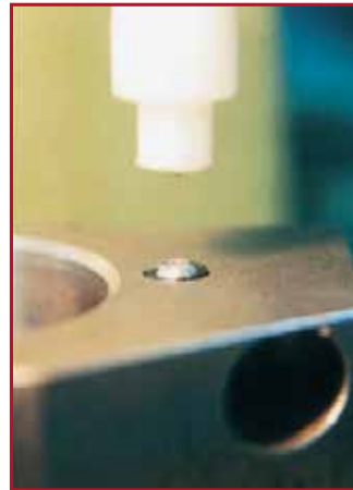
Eindrücken der Düse mittels Spezialwerkzeug.
