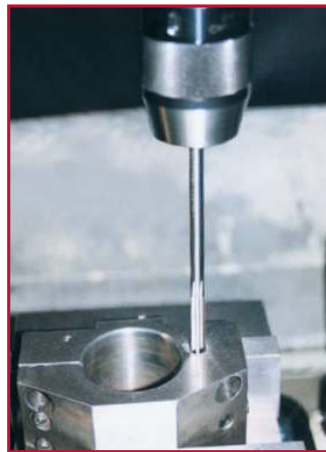
Vorbereitete Bohrung reiben, \varnothing -0 bis -0,05
