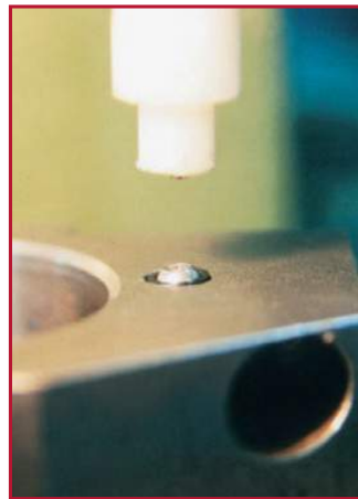
Eindrücken der Düse mittels Spezialwerkzeug.
